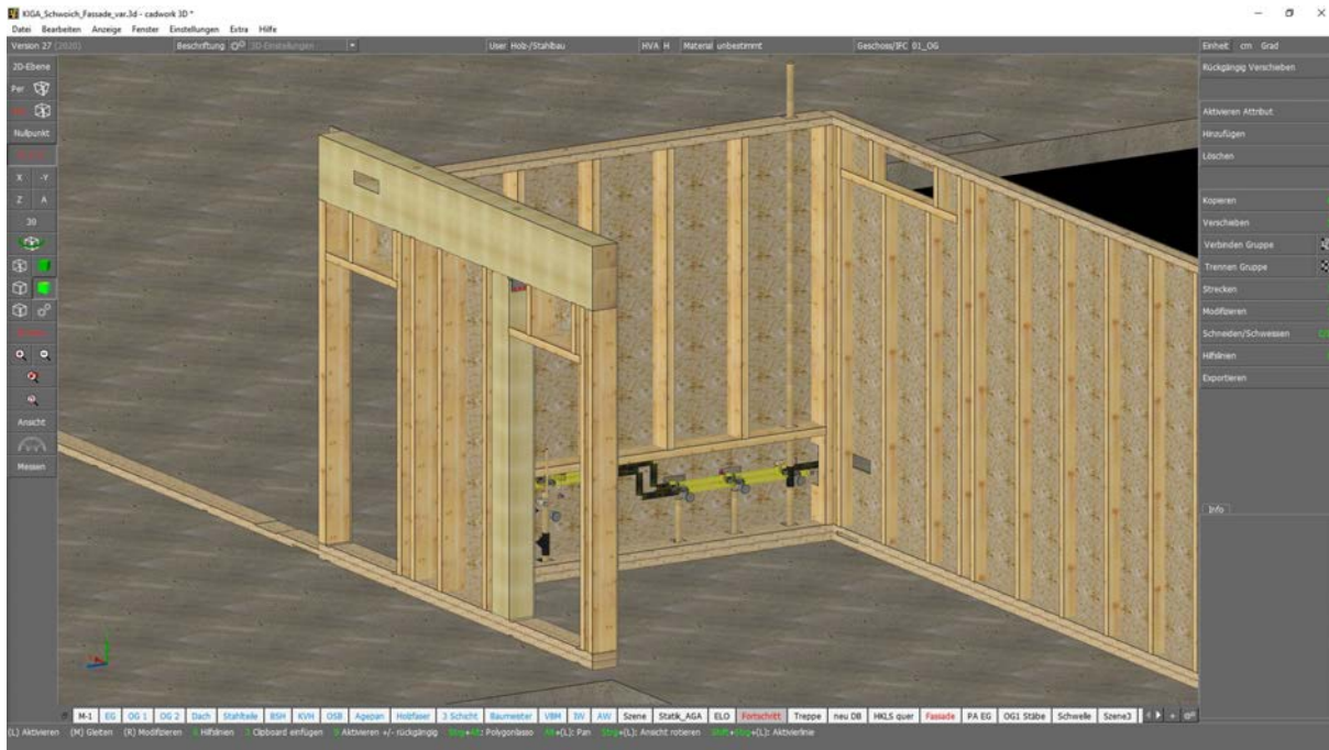
Abbildung 2.6-4: Ausführungsplanung in cadworks – Berücksichtigung Gebäudetechnik
