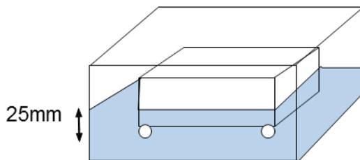
Das Kunststoffgefäß mit Salzlösung und Probenkörper wird in die Klimakammer gestellt und danach wird eine zyklische Veränderung von Temperatur und Feuchte durchfahren: Es werden 20 Zyklen durchfahren, ein Zyklus dauert 22h.
