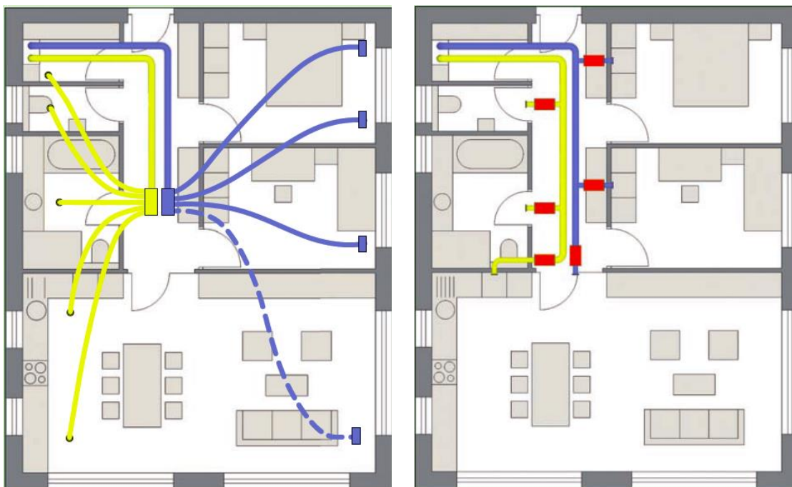
Abbildung 27: Schematische Darstellung einer Sternverrohrung (links) und einer Verrohrung mit Abzweigern (Gremel, 2013)
