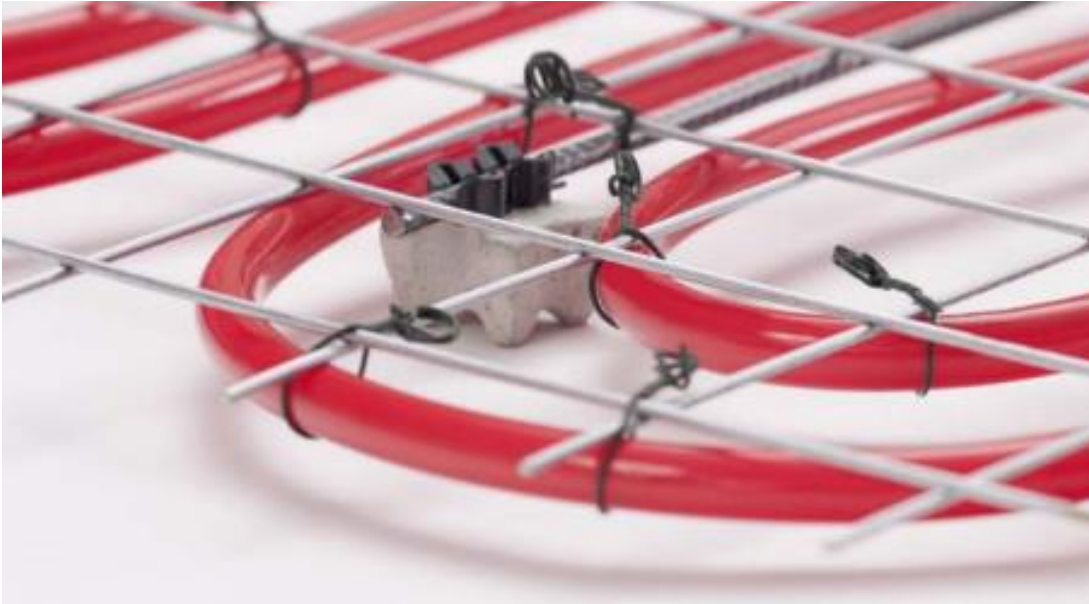
Abb. 6 | Modell einer oberflächennahen Betonkerntemperierung (oBKT): Das Rohrsystem liegt in der unteren Betondeckung der StB-Decke. (©Rehau)
