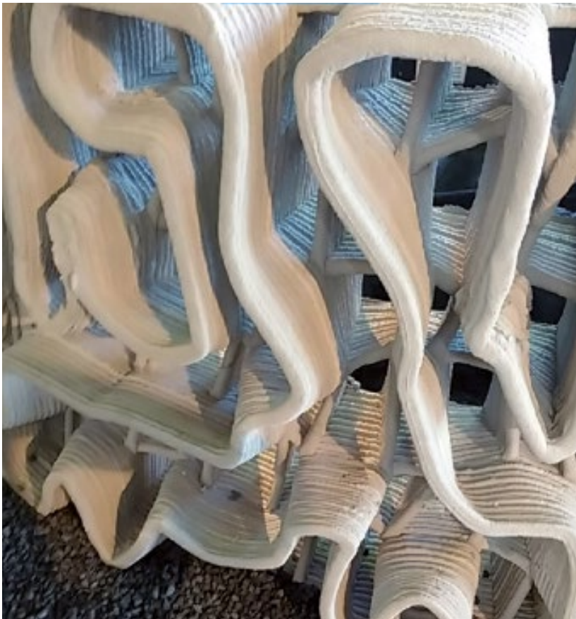
Die Universität Innsbruck forscht intensiv am 3-D-Betondruckverfahren.
