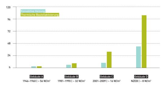
Während ein Gebäude mit einer durchschnitt-lichen Heizleistung von ca. 32 W/m² (Gebäude B) innerhalb von etwa 3 Stunden von 22 auf 20 °C operative Raumtemperatur absinkt, dauert für ein sehr gut gedämmtes Gebäude (Gebäude D) der gleiche Temperaturabfall rund 42 Stunden.
