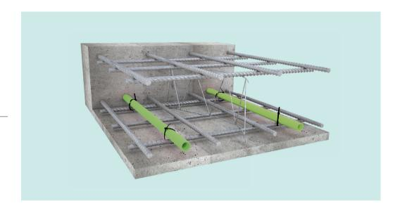
Die thermische Bauteilaktivierung (TBA) ist im Grunde eine einfache Technologie. Sie ist seit vielen Jahren ein Standardsystem für Heizung und Kühlung im gewerblichen Bereich und ist zunehmend auch in Wohngebäuden auf dem Vormarsch. Mit Klimaveränderung und Energiewende wird insbesondere die Ausnutzung der Speicherkapazität zunehmend interessant.
