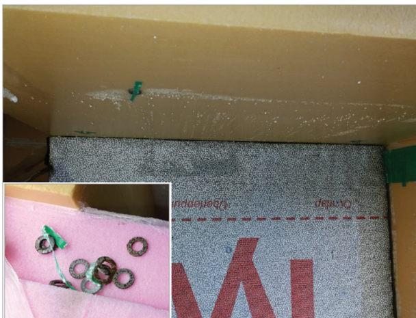
Kleinversuch: Kondensat und verrostete Schrauben beim Kleinversuch mit Dampfbremse mit geringem sd-Wert.
