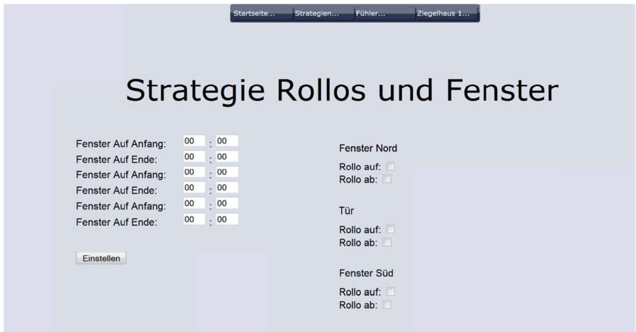
Abbildung 8: Einstellung der Zeitpunkte zu denen Fenster geöffnet bzw. geschlossen werden bzw. ob der Sonnenschutz in der Stellung oben oder unten ist.
